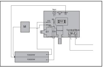
Fig. 3 - FX20V Wiring Diagram
